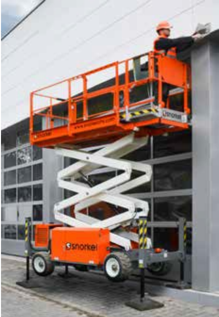
S2255RT/S2755RT Kapeat dieselkäyttöiset saksinostimet S2255RT ja 2755RT on suunniteltu erityisen ahtaiiin tiloihin, joihin standardilevyisillä nostimilla olisi vaikeuksia päästä. Voimakkaalla nelivedolla ja oskilloivalla taka-akselilla varustetut nostimet selviytyvät vaikeastakin maastosta helposti.
