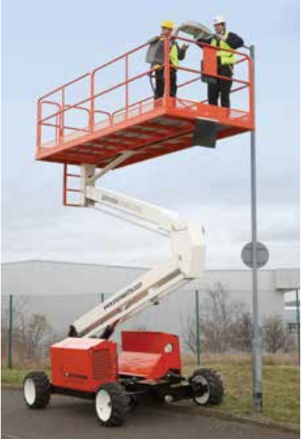
SL26SL/SL30SL SPEED LEVEL SL26SL selviää turvallisesti 680 kg korikuormasta ja 10 m työkorkeudesta. 1,72 x 3,66 peruslavalle on saatavilla vielä 0,91 m jatkolava. Tilavalla 1,72 m x 4,23 m lavalla varustettu SL30SL selviää 590 kg korikuormasta ja 11 m työkorkeudesta. Molempia malleja voidaan ajaa lava täysin ylhäällä ja erittäin kaltevilla pinnoilla kuten parkkihallien ajoliuskat yms.
