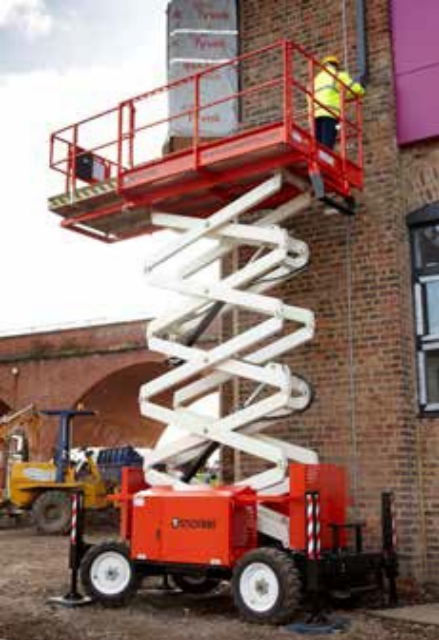
S2770RT/S3370RT/S3970RT Kevyet ja kompaktit S2770RT-, S3370RT – ja S3970RT – nostimet ovat käyttökelpoisia rakennusten välisissä ahtaissa tiloissa tehtävissä ulkotöissä. Erinomaisen maavaran ja oskilloivan akselin ansiosta ne selviytyvät vaikeistakin pintojen vaihteluista. Vakiovarusteena automaattisesti niveltyvät tukijalat ja 1,2 m työnnettävä jatkolava.
